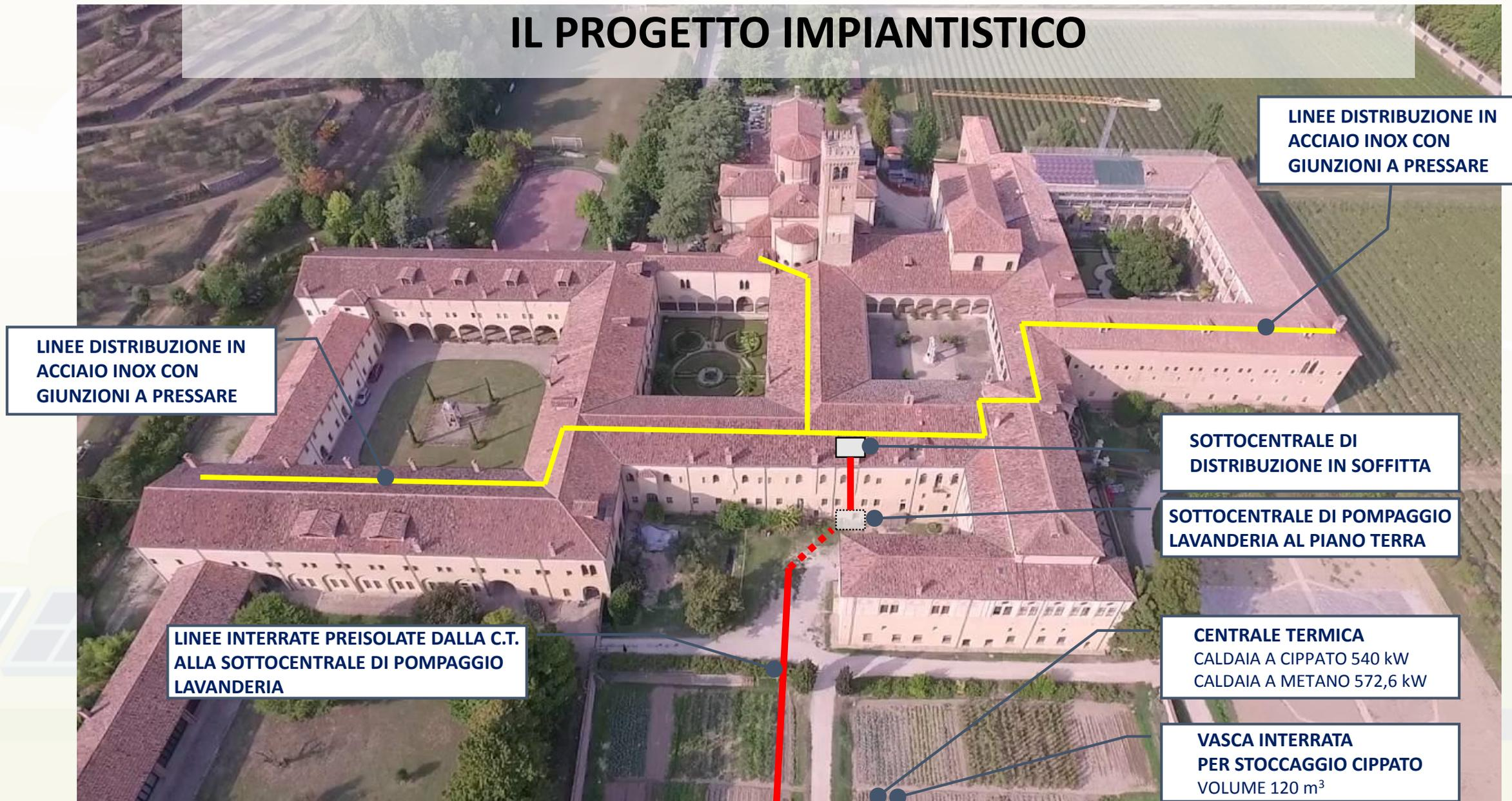
LINEE DISTRIBUZIONE IN ACCIAIO INOX CON GIUNZIONI A PRESSARE
